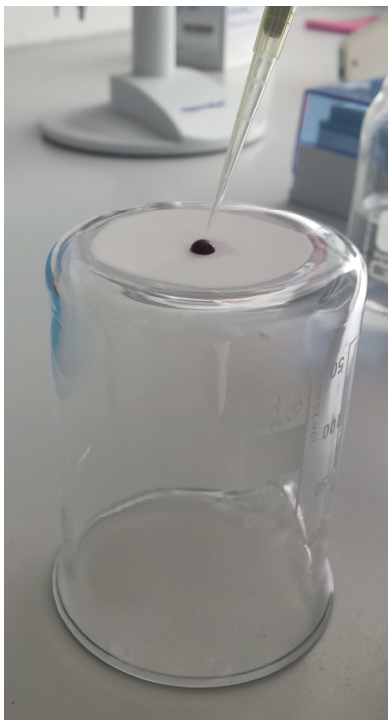
Abb. 2 Versuchsaufbau Die Membran liegt auf dem Rücken eines Becherglases. Mit einer Pipette werden das Blut und PBS aufgetragen.
